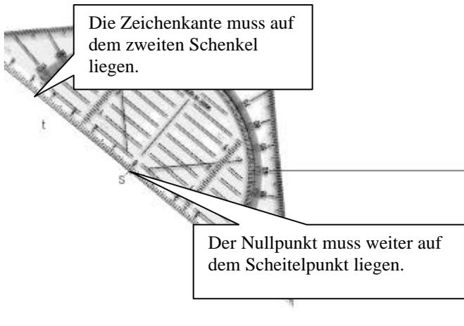
3. Jetzt kannst du am ersten Schenkel des Winkels auf der Skala des Geodreiecks die Winkelweite ablesen: in diesem Beispiel erhältst du eine Winkelweite von  $140^\circ$ . Diese Weite ist vernünftig, da der Winkel stumpf ist.
