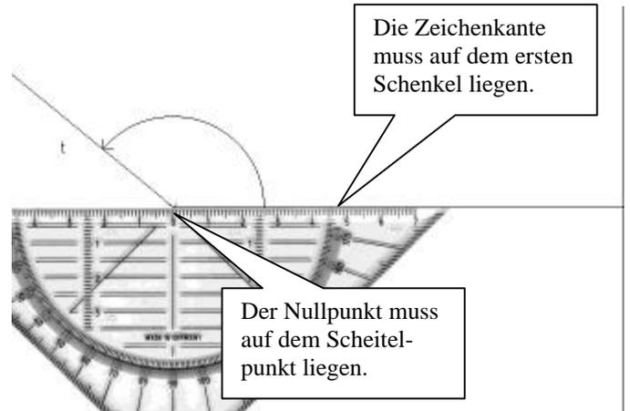
2. Drehe das Geodreieck so lange gegen den Uhrzeigersinn, bis die Zeichenkante des Geodreiecks auf dem zweiten Schenkel des Winkels liegt. Der Nullpunkt des Geodreiecks muss weiter genau auf dem Scheitelpunkt liegen.
