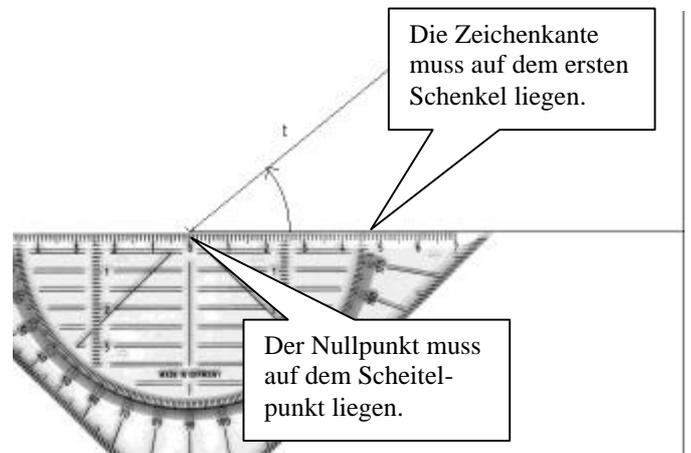
2. Drehe das Geodreieck so lange gegen den Uhrzeigersinn, bis die Zeichenkante des Geodreiecks auf dem zweiten Schenkel des Winkels liegt. Der Nullpunkt des Geodreiecks muss weiter genau auf dem Scheitelpunkt liegen.
