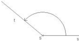
1. Lege die Zeichenkante des Geodreiecks so auf den ersten Schenkel des Winkels, dass der Nullpunkt des Geodreiecks genau auf dem Scheitelpunkt des Winkels liegt.
