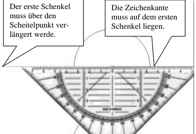
2. Drehe das Geodreieck um  $180^\circ$  gegen den Uhrzeigersinn, so dass die Zeichenkante des Geodreiecks auf der Verlängerung des ersten Schenkels liegt. Der Nullpunkt des Geodreiecks muss genau auf dem Scheitelpunkt liegen.
