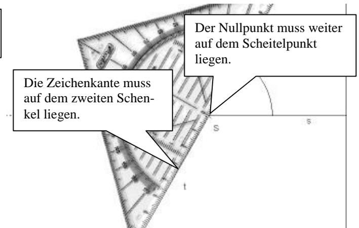
4. Jetzt kannst du an der Verlängerung des ersten Schenkels auf der Skala des Geodreiecks eine Winkelweite ablesen: in diesem Beispiel erhältst du eine Winkelweite von  $60^\circ$ .
