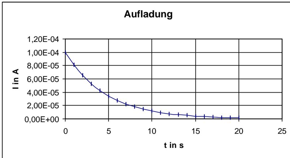
**2. Schritt:** Bestimme durch Berechnen des Flächeninhalts von (hier: 5) Trapezen die bis zu einem bestimmten Zeitpunkt t (hier: t=10s) insgesamt auf den Kondensator geflossene Ladungsmenge Q(t) (hier: Q(10s)):
